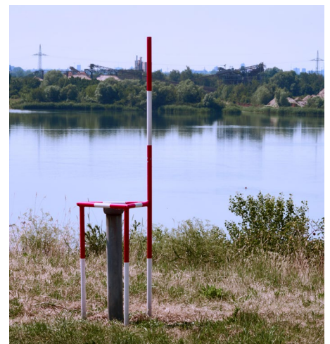
Figure 3 Le puits de surveillance des eaux souterraines figurant sur cette photo est un élément courant des activités d'assainissement.
